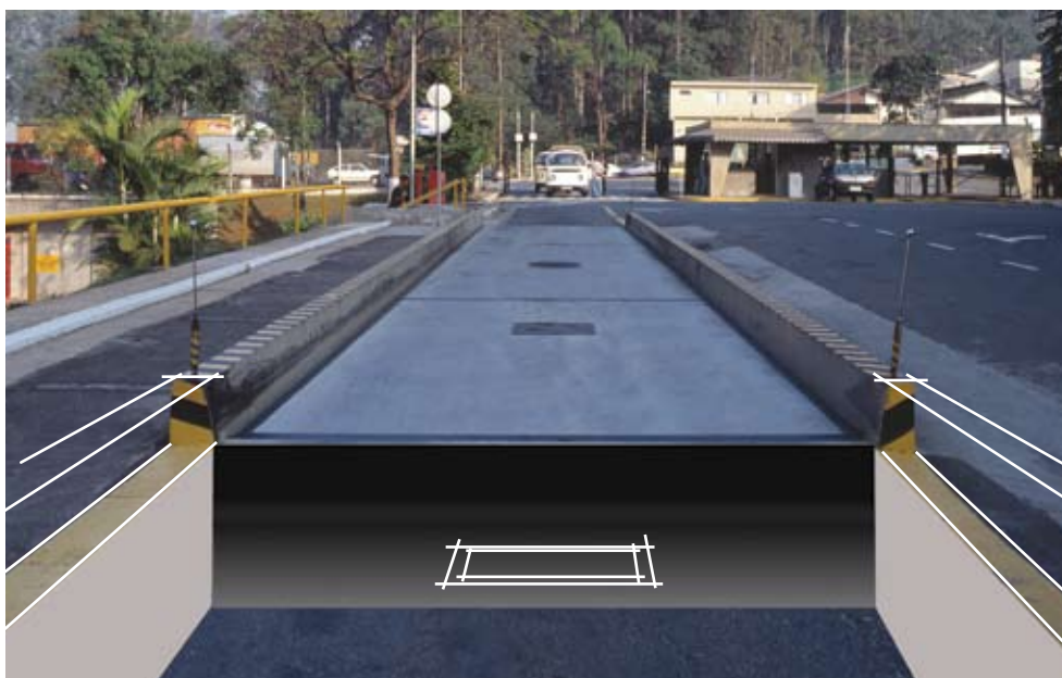
Ilustração simplificada de projeto de prolongamento de uma balança rodoviária
