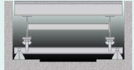
Balança mecânica ou eletromecânica com alavancas, cutelos e coxins.
